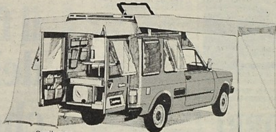
Ognitempo Un "kit" di montaggio trasforma il 127 Fiorino da veicolo da lavoro in veicolo per il tempo libero: il più piccolo ed economico camper del mondo.
